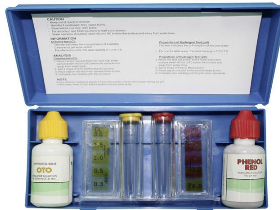
Συσκευή μέτρησης υπολειμματικού χλωρίου & pH
